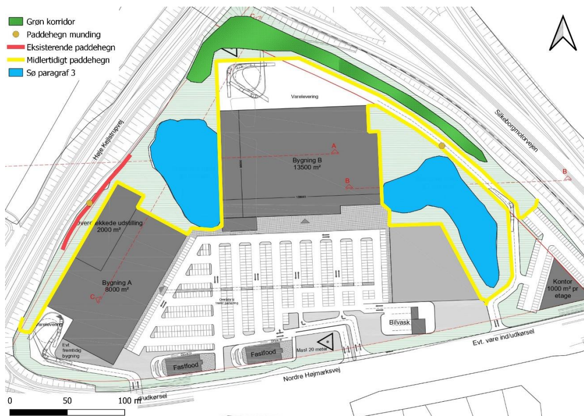
Figur 3 - Kort over byggeplan. De gule streger markerer det midlertidige paddehegn, der skal etableres forud for byggefasen, for at sikre at padder holder sig ude af byggeområdet og i sikkerhed. Den røde streg markerer det eksisterende paddehegn, og de orange prikker markerer paddetunneler. Det grønne område markerer en grøn korridor, der skal etableres nord for byggeområdet.
